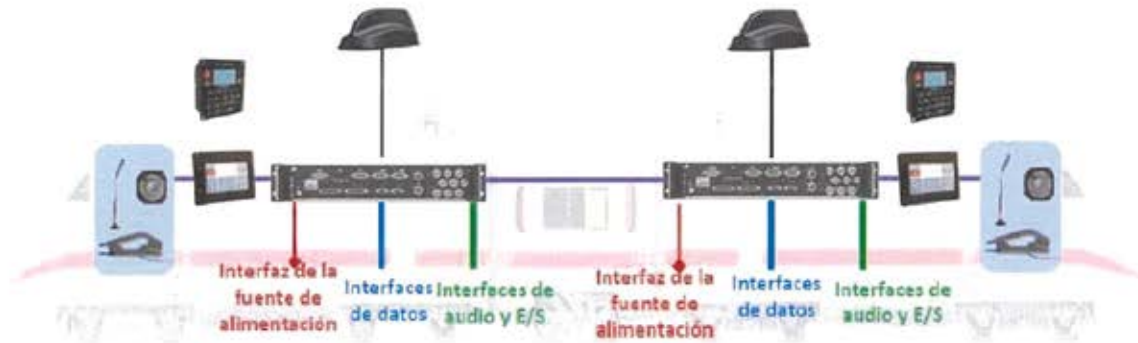
Figura 23 Topología del terminal TETRA embarcado
